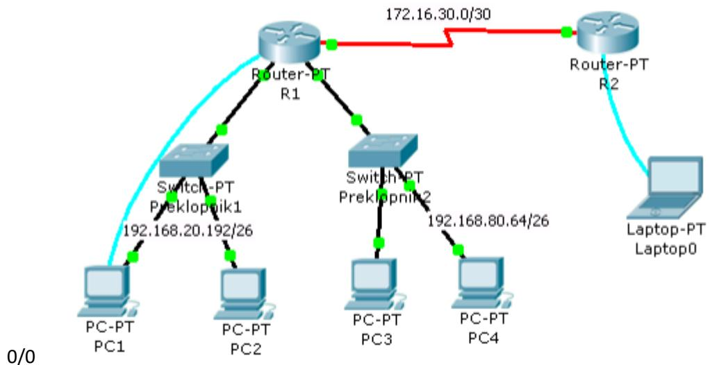
1. U PT-u spoji uređaje prema zadanoj topologiji i izvrši temeljnu konfiguraciju usmjernika, koristeći spojena računala kao terminale (rollover kabel). Na R2 također dodaj terminal radi konfiguracije.
